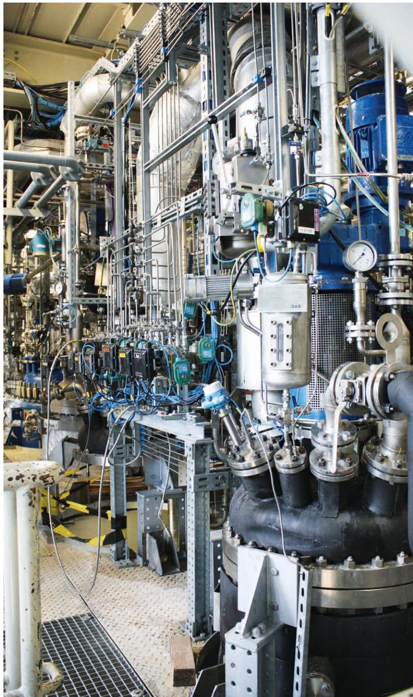
*Kautschuksynthese im Pilotmaßstab (600 L Reaktor).*
