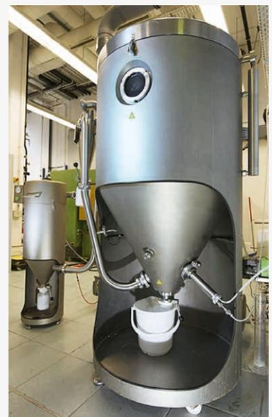
Aufskalierungsequipment mit 100 L Batchreaktor (links), halbkontinuierlicher Zentrifuge (Mitte) und Sprühtrockner im Technikumsmaßstab (rechts).
