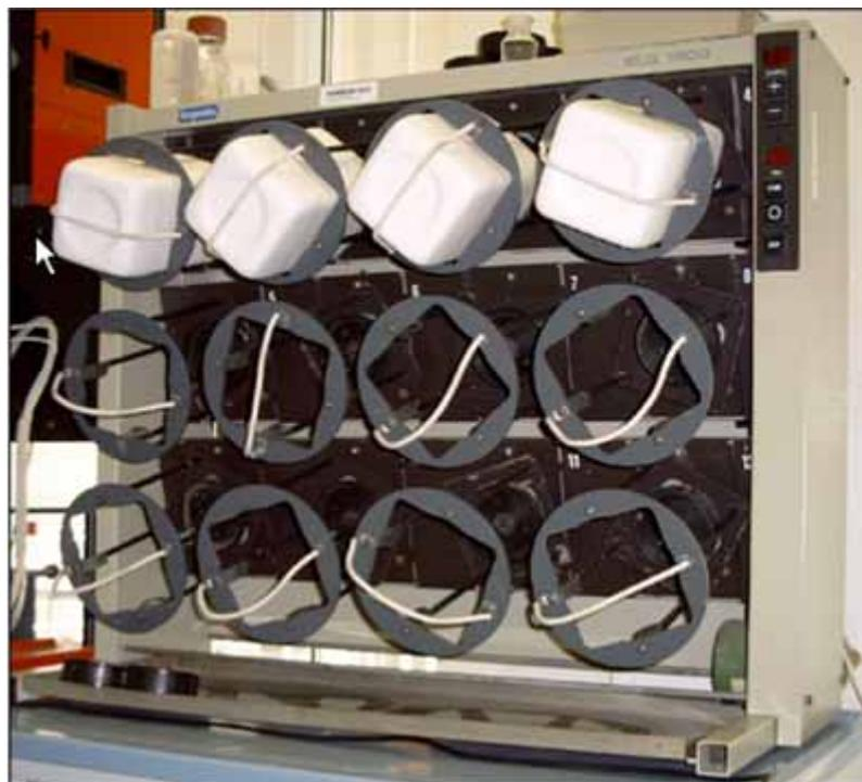
**Abb. 1:** Elutionsapparatur: ELG 1200; Fa. Forgenta
