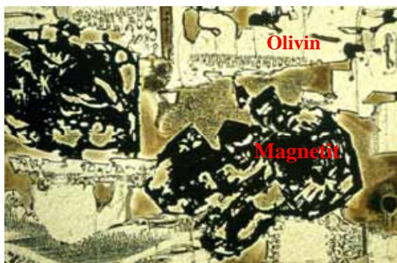
**Abb. 11:** Große Magnetitkristalle und gefärbte Glaseinlagerungen, umwachsen von einem Olivinkristall; durchlichtmikroskopische Aufnahme (ohne Analysator, Bildbreite: 0,56 mm)
