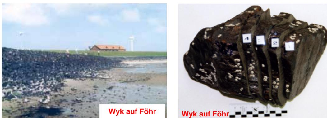
**Abb. 17, 18:** Probenentnahmestelle Wyk auf Föhr; Eisensilikat-Gesteine, zum Teil stark mit Seepocken bewachsen, in 4 Scheiben von ca. 2 cm Stärke zersägt
