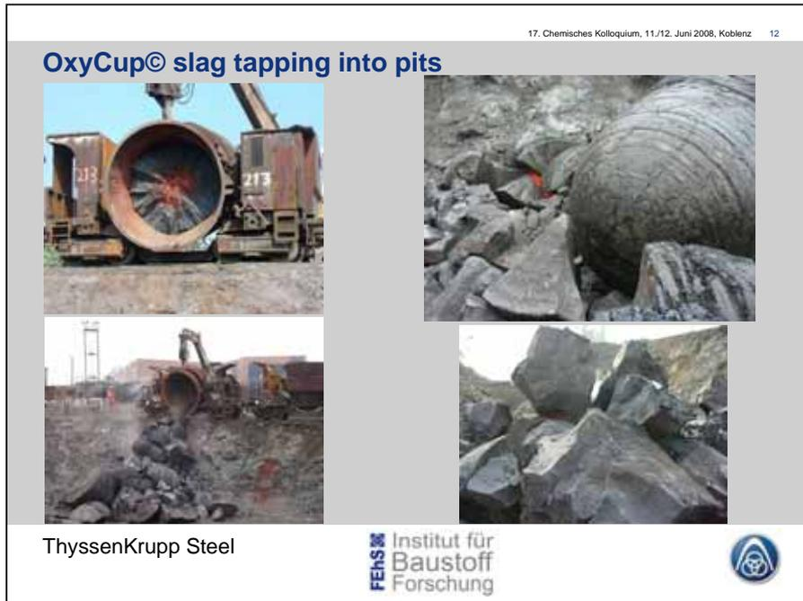
**Abb. 7:** Abkippen der erstarrten Schachtofenschlacke in das Schlackenbeet
