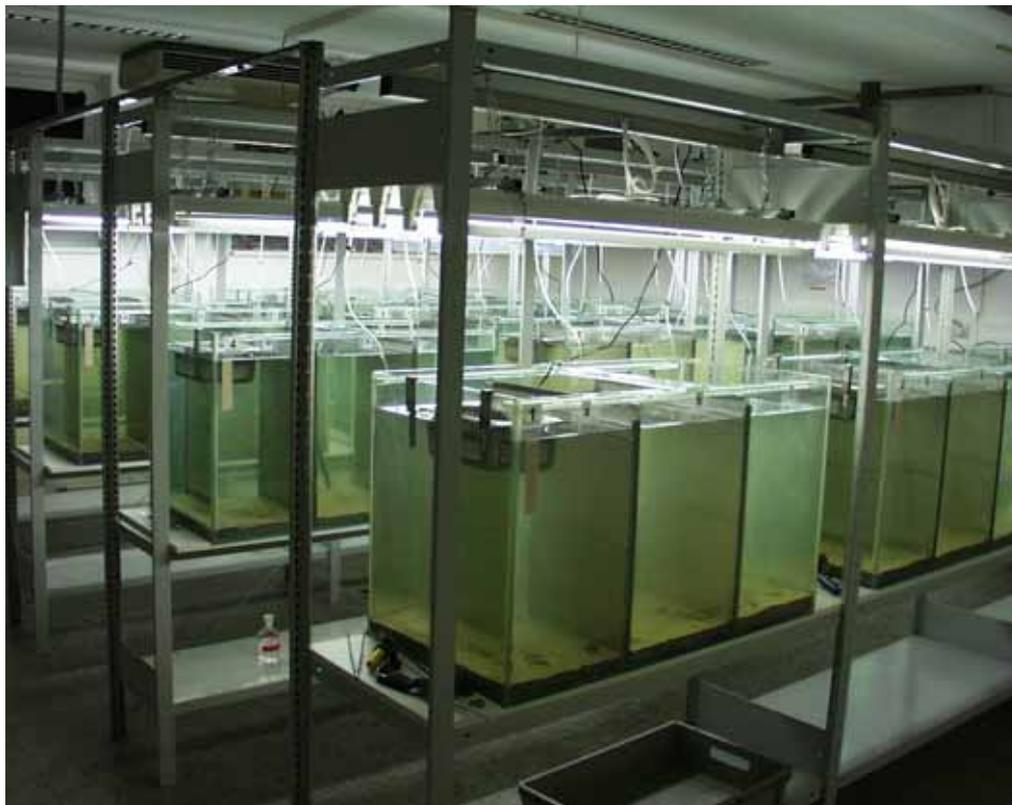
**Abb. 1:** Versuchsanlagen zur Untersuchung der Elution und langfristigen Auswirkungen von Eisensilikatgestein aus der Kupfergewinnung. Oben: *Enclosure*-Anlage der Mesocosm GmbH, unten: *Fish Full Life Cycle Test* am Fraunhofer IME
